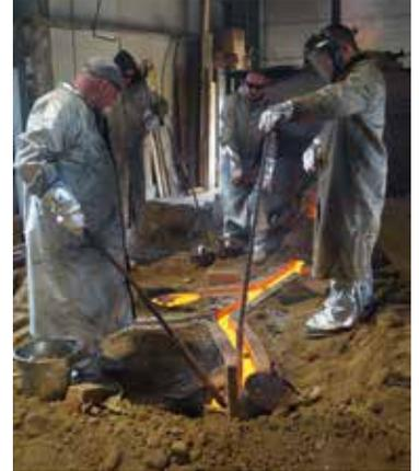
Glocken sind versenkt in einer 4m tiefen Grube, mit Lehm verfüllt und oberirdisch umhüllt. Mit einem Fichtenstamm wird die Glut im Ofen immer wieder geschürt. Die silbernen Feuerschutzanzüge sollen die Mitarbeitenden der Glockengießerei vor der Hitze schützen, wenn die Temperatur gemessen wird und Proben von der Bronze genommen werden.
